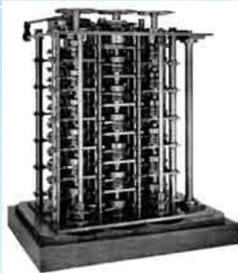
เครื่องผลต่างของแบบเบจ (Babbage's Difference Engine)
